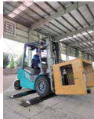
Погрузчик проходит испытание, имитирующее ухабистую дорогу
