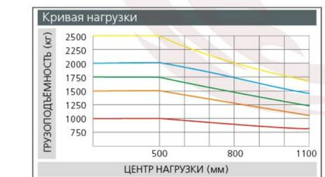
**Примечание:** Вертикальная ось соответствует грузоподъемности, а горизонтальная ось соответствует центру нагрузки, измеренному от передней стороны вил до центра тяжести стандартного груза. Стандартным грузом считается куб со стороной 1000 мм. Грузоподъемность уменьшается в случае наклона мачты вперед, использования нестандартных вилок или негабаритного груза. С помощью этой диаграммы нагрузки можно определить грузоподъемность стандартной мачты для различных значений центра нагрузки.
